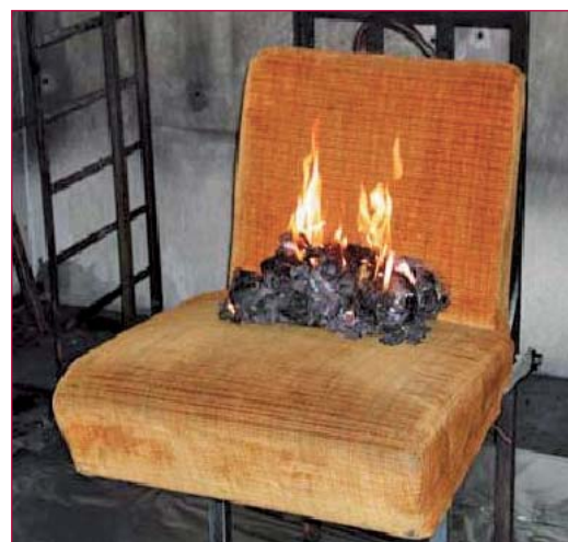
Prova del cuscino di carta da 100 g su un sedile. 100 g paper cushion test on a seat.
