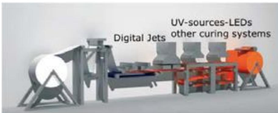
Figura: processi di spalmatura futuri basati sulla spalmatura digitale e su unità di polimerizzazione LED e ai raggi ultravioletti in linea (Progetto UE Digitex)
